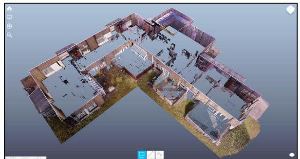
Billede 25: Punktsky udarbejdet med Leica BLK360
