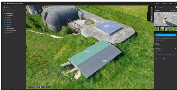
Billede 26: Automatisk skaleret dronemodell med opmålinger i Pix4Dcloud
